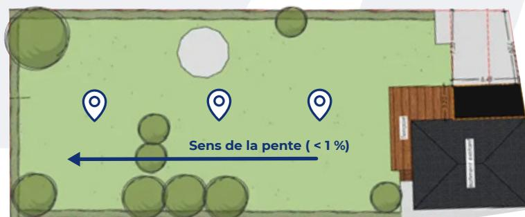
Sondage et test de perméabilité
